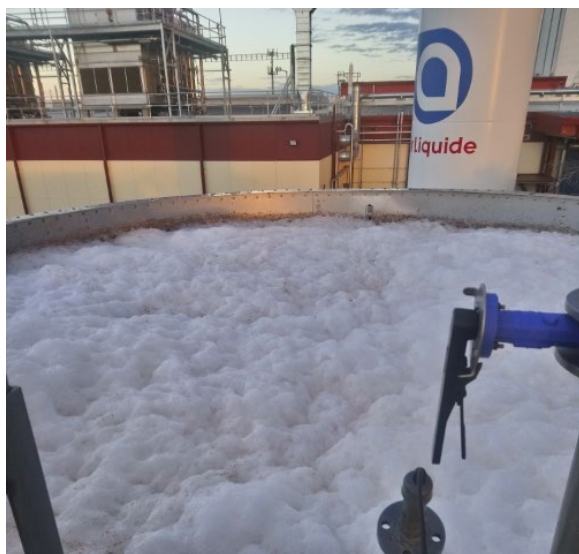
03 Espuma en un recipiente de descarga en la industria del petróleo y gas
