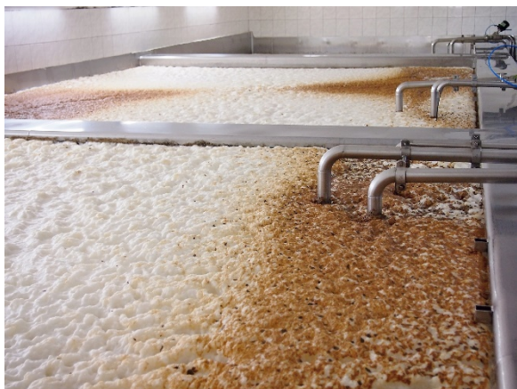
06 Espuma durante la fermentación en el proceso de elaboración de la cerveza
