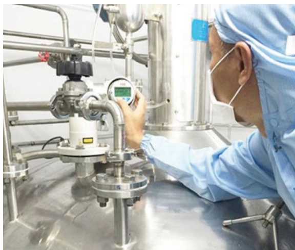
07 Medición de la espuma en un tanque de cristalización con agitador
