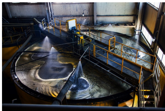
04 Espuma en tanque de flotación en la industria minera
